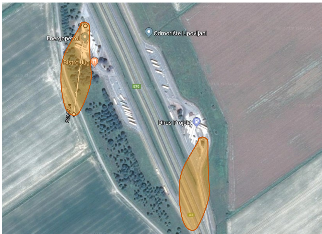
Slika19: Lokacija INA BP Lipovljani sjever i jug-radijusi ugrože prema SLAB View metodi Izvor podataka: Planovi i Procjene j.d.o.o.
